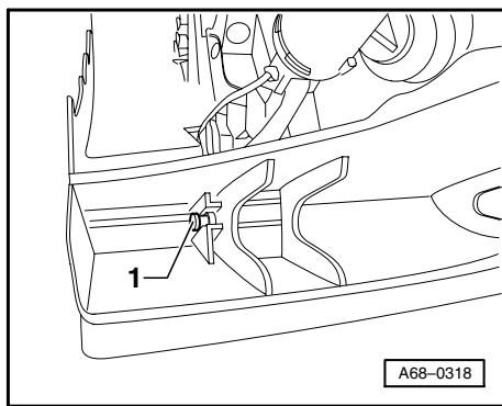
► - 在手套箱右侧拆下销子 -1-。
