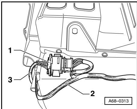
图 2 脱开手套箱引线 / 导线束的插头连接
