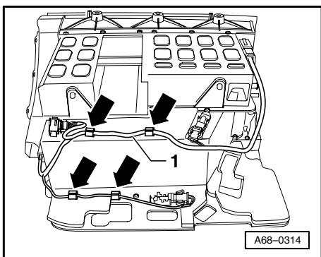
图 3 固定手套箱导线束
